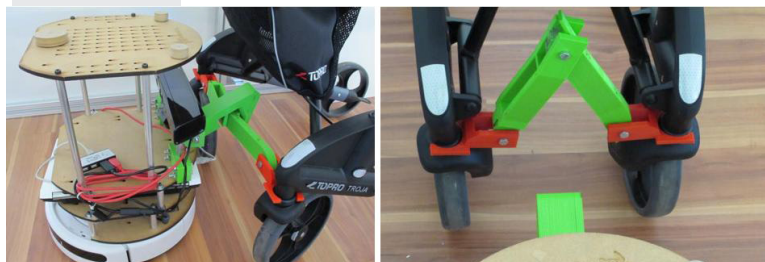
圖 13. TurtleBot 透過助行車與機器人之間的連接器拖動助行車
