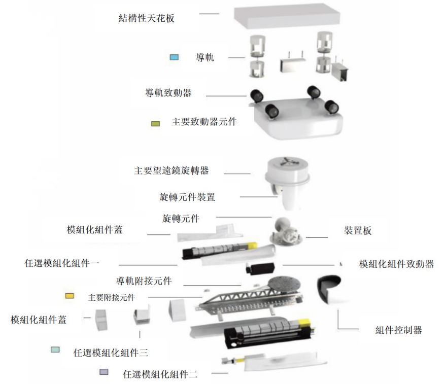
圖 2. 複合式機器人輔助系統總覽 (Linner et al., 2012)
