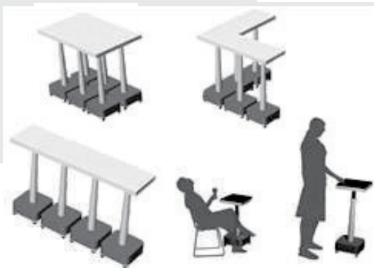
圖 5. MiniOn 輔助機器人的組合配置 (Ulbricht & Chervyakov, 2015)
